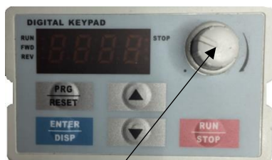
Potenciometer POT na externom paneli
